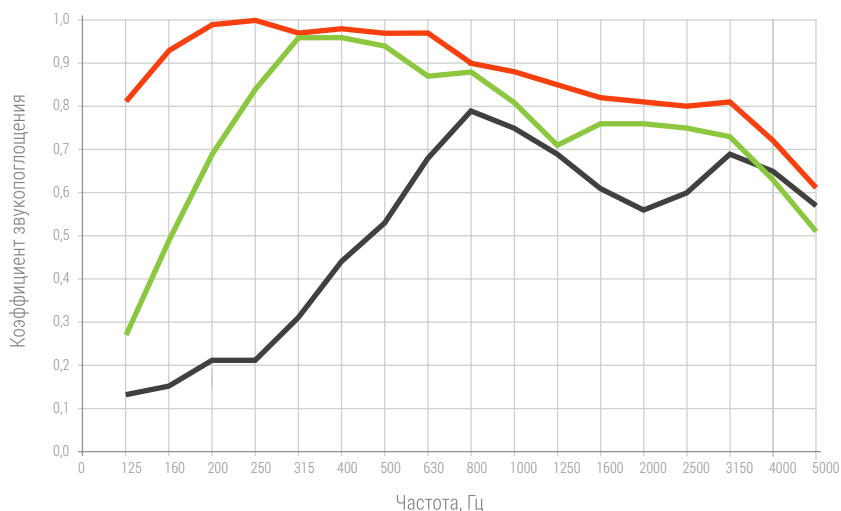
Частотные характеристики коэффициентов звукопоглощения для материала Soundec
